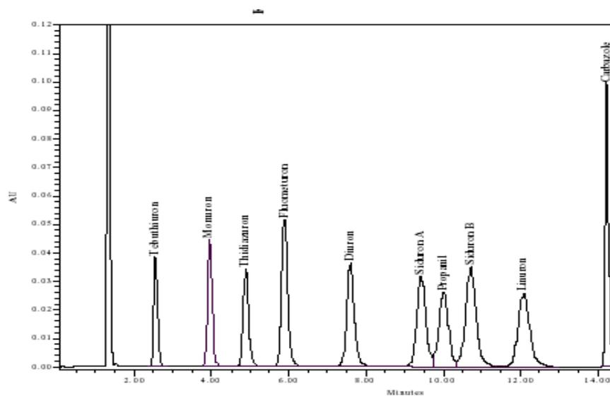
图 2：确认柱-氰基柱：分离结果
